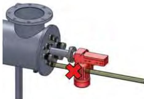
Dévisser les vis de serrage et tourner le moteur de nettoyage:
