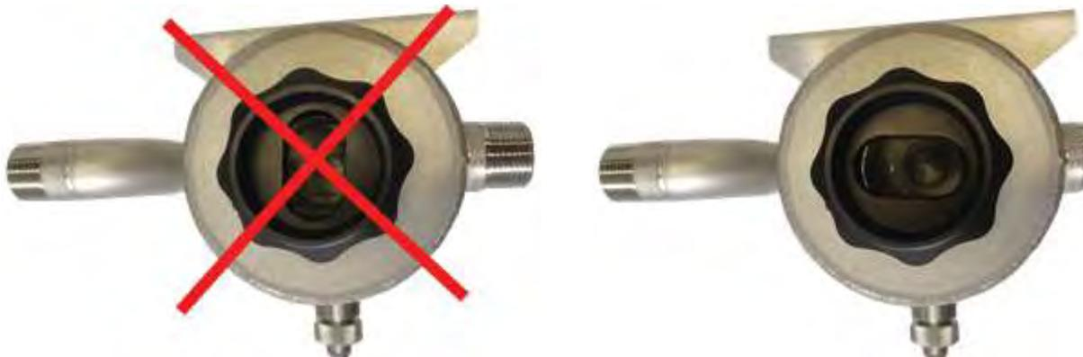
La lampe doit également être équipée avec un joint torique EPDM (28 x 1,5 mm) à 1 cm de son extrémité pour éviter le contact entre la lampe et le quartz. Le joint torique est fixé avec un fil PTFE.
